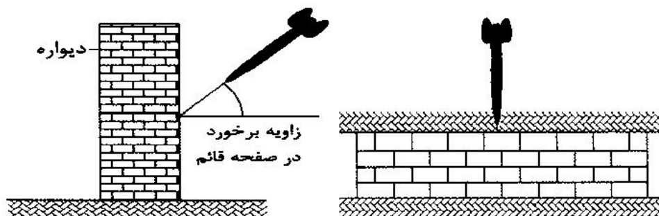
شماپیک زاویه برخورد پمپ با سطح سازه
